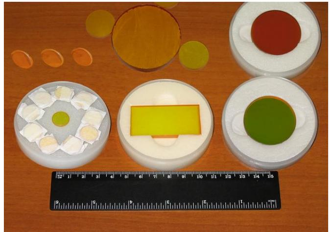
硒化锌材料用来制作全反射镜、半反射镜、扩束镜、平场透镜、中红外镜片、远红外 10.6 $\mu\text{m}$ /CO<sub>2</sub> 大小功率激光器上各种平凸透镜、凸凹月牙切割透镜、镀金反射镜、圆偏振镜、扩束镜、平场透镜等，广泛应用于激光、医学、天文学和红外夜视等领域中。
